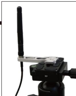
アンテナは付属のアンテナホルダでカメラ用の三脚に固定して使用可能
